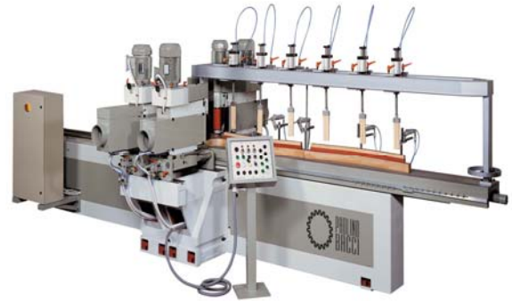
Máy chép hình dọc theo profile (Paolino Bacci)
