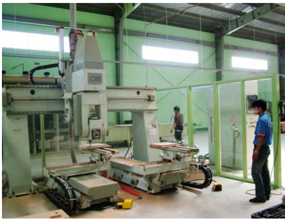
6 Axes CNC Machine Master (Paolino Bacci) Máy CNC 6 trục chuyên phay, khoan, bào, làm mộng
